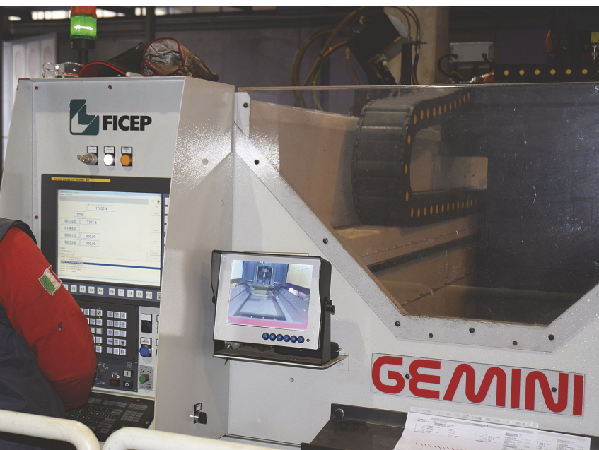
Cnc Ficep Pegaso con monitor aggiuntivo per un miglior controllo del campo di lavoro.
